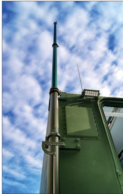
Oft muss für die Installation eines neuen Mastsystems das Fahrzeugdach durchbrochen werden (Fotos: Norrenbrock Technik)
