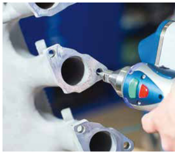
Um präzise Datensätze zu erhalten, werden konstruktionsrelevante Merkmale per Hand gescannt.
