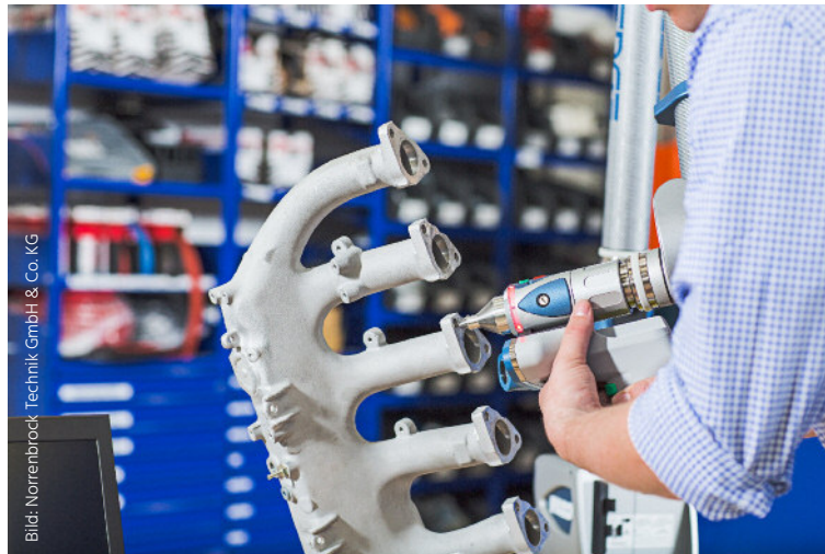
Beim 3D Reverse Engineering zur Flächenrückführung oder Nachkonstruktion wird ein Objekt mittels 3D-Scan exakt abgebildet und auf dieser Grundlage rekonstruiert.
