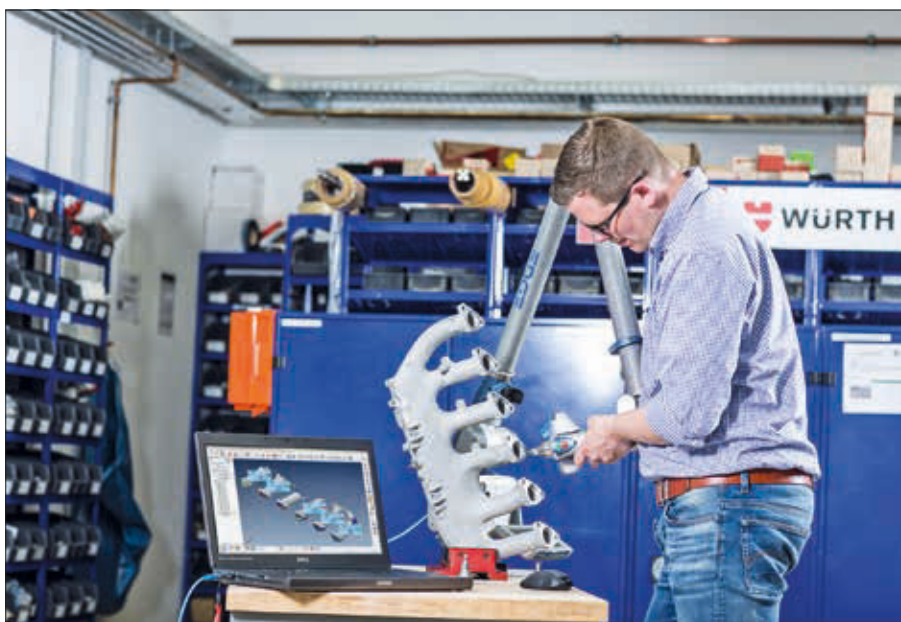
Im Gegensatz zur funktionellen Nachempfindung bildet das Reverse Engineering das vorliegende Objekt mithilfe eines 3D-Scans detailgetreu ab.
