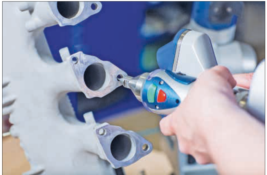
Alle konstruktionsrelevanten Merkmale eines vorliegenden Original-Bauteils werden mit einem handgeführten 3D-Scanner der Marke Faro Technologies extrahiert.
