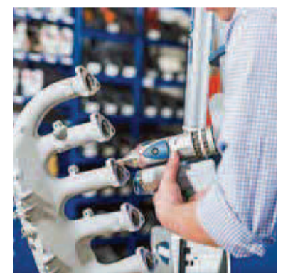
Das Reverse Engineering bildet das vorliegende Objekt mit einem 3D-Scans exakt ab.
